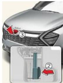
1. Entriegelungshebel ① betätigen, um die Motorhaube zu entriegeln. Die Motorhaube sollte sich etwas öffnen.
