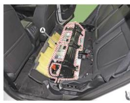
6. Befestigung der Einstiegsleiste der Hecktür (A) entfernen.
